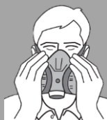
Test d'étanchéité à pression négative
