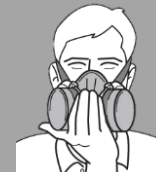
Test d'étanchéité à pression positive
